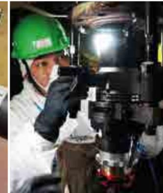
> Maschinelle Bearbeitung vor Ort, in einer mit ionisierender Strahlung belasteten Umgebung, mit einer Bearbeitungsmaschine vom Typ SERCO TU
