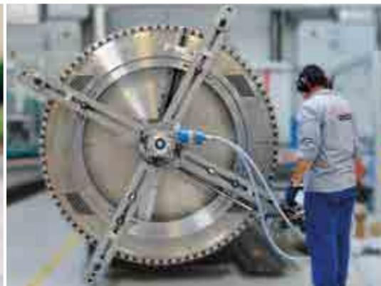
> tragbare Bearbeitungsmaschinen, die die Wartung und Reparatur von Flanschen und Ventilen ermöglichen
