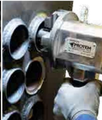
> Schweißnahtentfernung für das Heraustrennen von Rohren mit der Anfasmaschine für Rohre PROTEM US30CH
