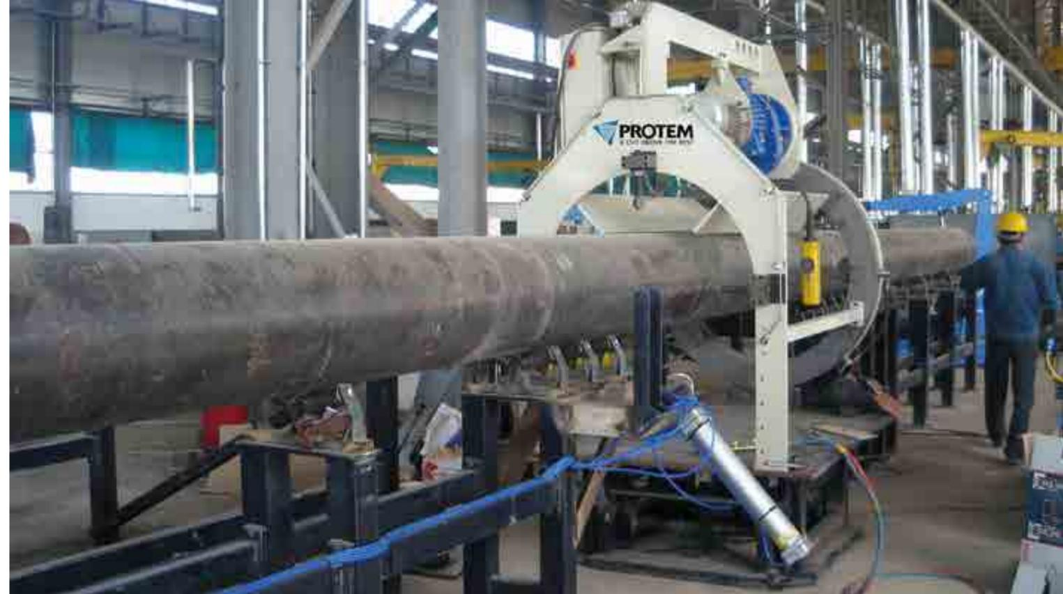
> Vorfertigung von Rohren vor Ort oder im Betrieb mit einer Trenn- und Anfasmaschine PROTEM Typ TNO
