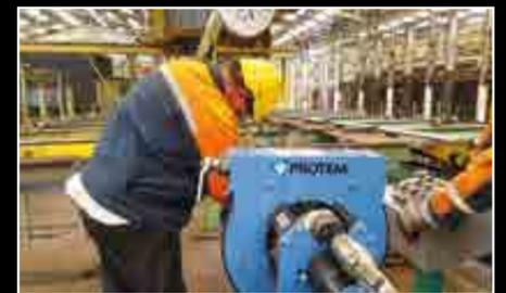
> Mobile Anfasbank PROTEM BMFM für die maschinelle Bearbeitung von sehr dickwandigen Rohren
